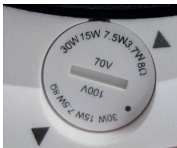
Рис. 7. Установка положения переключателя отводов трансформатора
